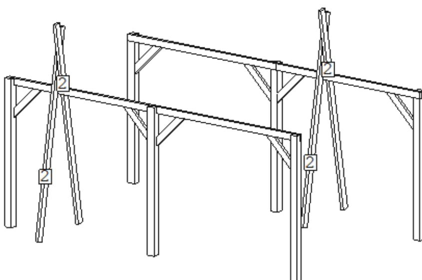
Das Portal am Aufstellort aufrichten. Verwenden sie zur Abstützung zwei mit Schraubzwingen (oder Schrauben) gehaltene Sparren « 2 », um das Portal in sicherer Senkrechtposition zu halten.
