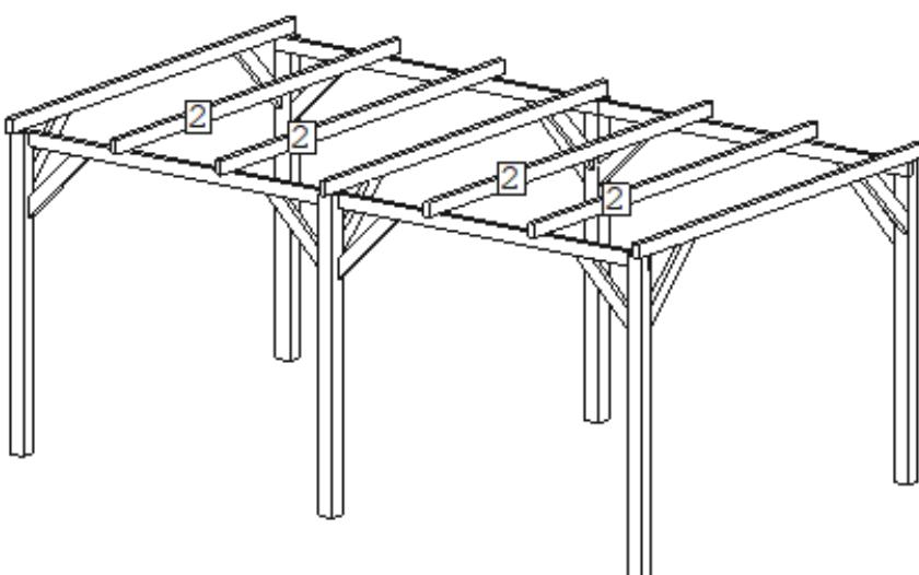
Bauen sie die Abstützungen wieder ab und befestigen sie die Pfetten « 2 » an deren Montageort (Mittenversatz von ca. 102 cm).
