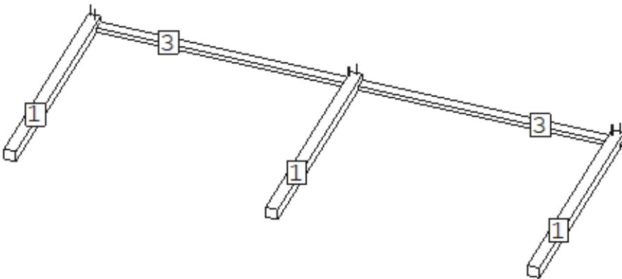
Assembler les portiques (poteaux « 1 » + traverse haute « 3 » + bras « 4 »). Percer Ø 5 et visser les traverses « 3 » aux poteaux « 1 » (2 vis 5/100)
