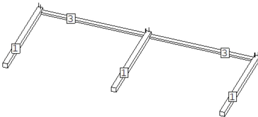
Stellen sie das Portal zusammen (Pfosten « 1 » + oberer Balken « 3 » + Ausleger « 4 »). Querbalken « 3 » mit Ø 5 bohren und an die Pfosten « 1 » festschrauben (2 Schrauben 5/100)
