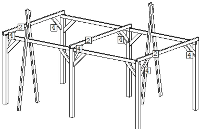
Positionieren sie die Sparren « 2 » an die Enden und in die Mitte. Bohren und verschrauben sie selbige (2 Schrauben 5/140).
