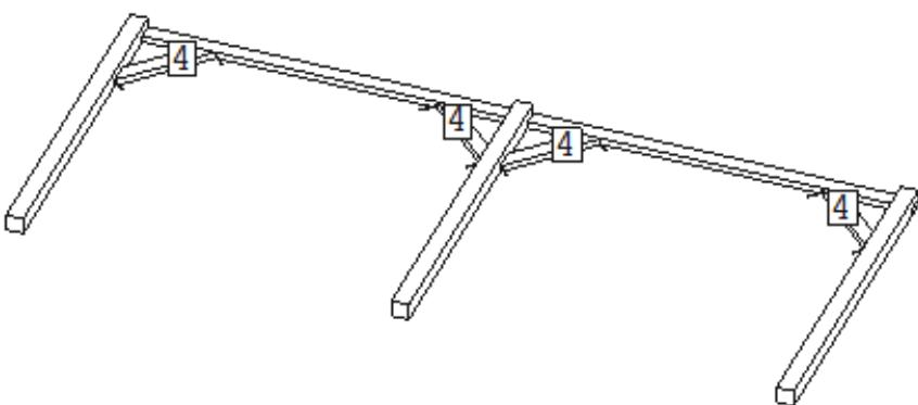
Percer Ø 5 et visser les bras « 4 » dans la traverse « 3 » et les poteaux (2 vis 5/140), en veillant au bon équerrage.
