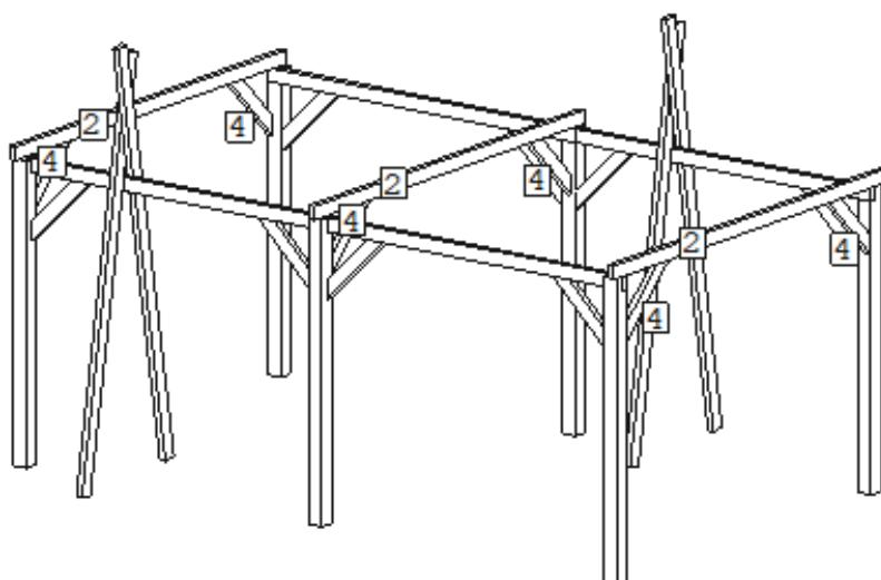
Poser les chevrons « 2 » aux extrémités et au centre - percer et visser (2 vis 5/140)
