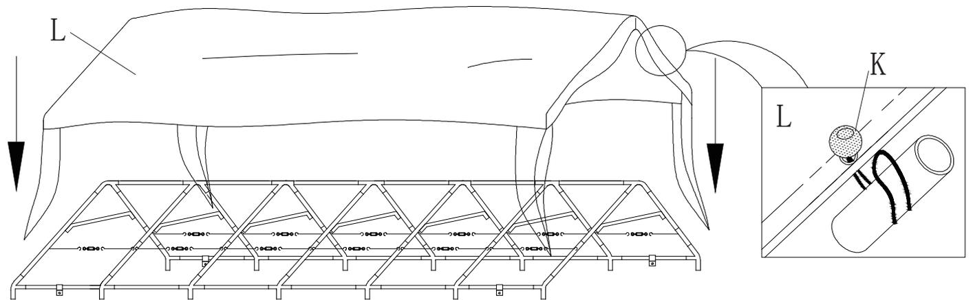
**5.** Verbinden Sie dann die Rohre 3 und befestigen Sie diese am gemäß 1. montierten Dachgestell.
