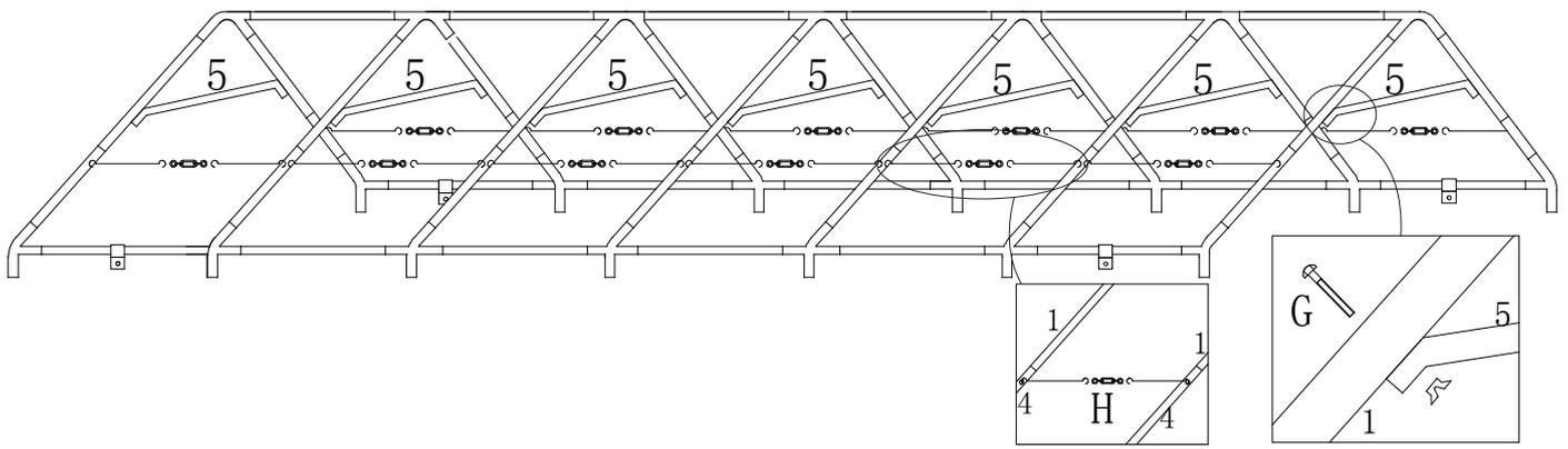
**4.** Positionner la toile sur la structure et fixer à l'aide des bandes velcro.
