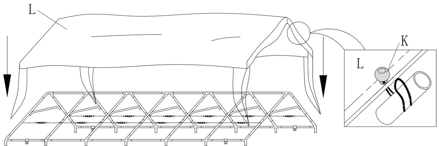
**5.** Assembler ensuite les tubes 3 et fixer les à la structure du toit montée en 1. .
