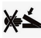
Attention aux risques de pincement et de cisaillement en cours d'installation et d'utilisation.
